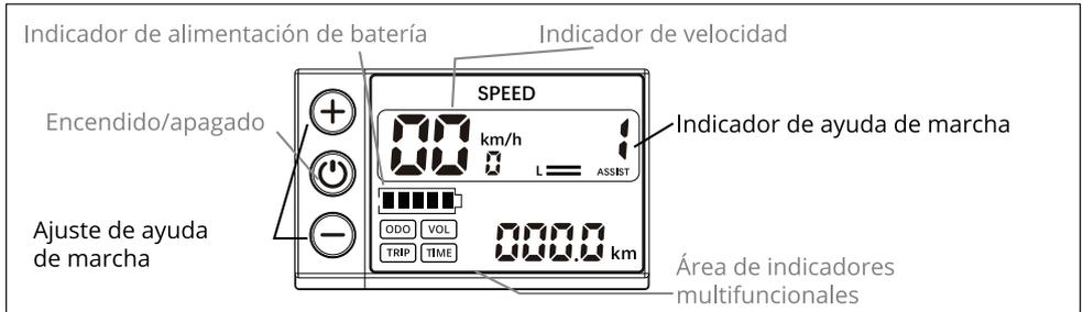
1. En el estado de apagado, mantenga pulsada la tecla de Encendido durante 3 segundos para poner en marcha la ebike;
